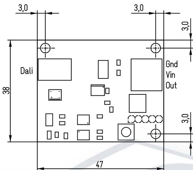
An den Ausgang OUT wird das Kathodenende (negativ) der LED angeschlossen, das Anodenende der LED wird mit der Versorgungsspannung verbunden. Es dürfen nur LED-Module, -Strips oder -Lampen verwendet werden, die für den Betrieb mit konstanter Spannung ausgelegt sind. Das LED-Warrior07-02MOD kann keine LEDs ansteuern, die Konstantstrom benötigen.
