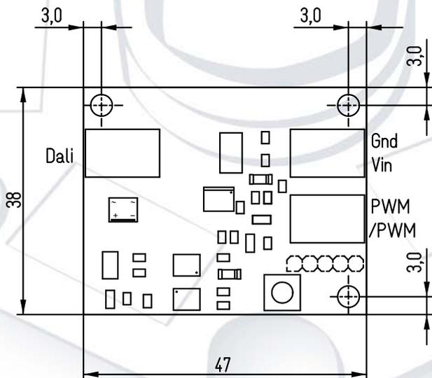
Das LED-Warrior07-01MOD erzeugt ein PWM-Signal zur Ansteuerung von LED-Treibern. LEDs können mit dem LED-Warrior07-01MOD nicht direkt betrieben werden, es ist ein geeigneter Treiber notwendig.
