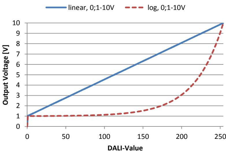
**Ausgangsspannung 1-10V bzw. 10-100%:**
