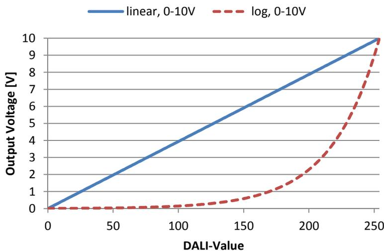
**Ausgangsspannung 0-10V bzw. 0-100%:**
