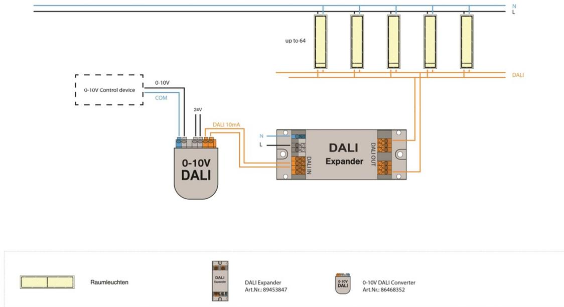
Steuerung von 64 DALI-Leuchten mit einem 0-10V Steuergerät in Kombination mit einem 0-10V auf DALI-Konverter (ArtNr: 86458352)
