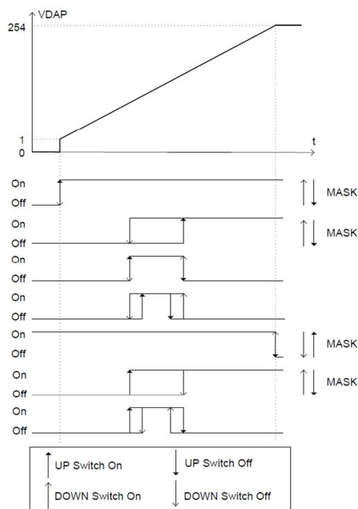
Mit dem Fading lassen sich Ein- und Ausschaltverzögerungen realisieren.
