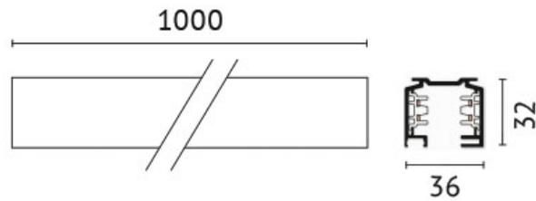
**Anschlussspannung:** 220-240 V
