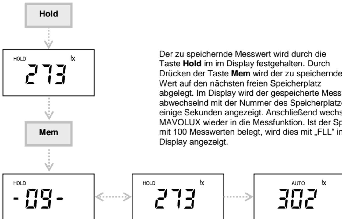
Der zu speichernde Messwert wird durch die Taste **Hold** im Display festgehalten. Durch Drücken der Taste **Mem** wird der zu speichernde Wert auf den nächsten freien Speicherplatz abgelegt. Im Display wird der gespeicherte Messwert abwechselnd mit der Nummer des Speicherplatzes für einige Sekunden angezeigt. Anschließend wechselt das MAVOLUX wieder in die Messfunktion. Ist der Speicher mit 100 Messwerten belegt, wird dies mit „FLL“ im Display angezeigt.
