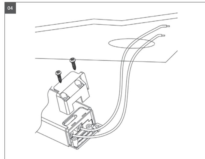
Anschluss Zuleitung an LED Konverter 230V 50Hz Kabel mit der Abdeckung = Zugentlastung schließen.
