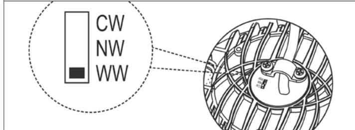
Wahlschalter Farbtemperatur. Bitte wählen Sie die Farbtemperatur (CW/NW/WW) vor der Installation.
