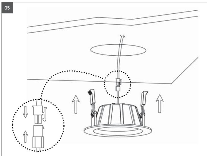
Kompaktstecker von der LED Leuchte mit LED Konverter verbinden (siehe Bild). Spannklemme nach oben drücken und Leuchte einsetzen.
