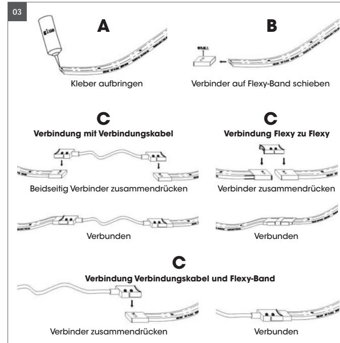
**03.** Schließen Sie das Ende mit der Verschlusskappe und Silikonkleber. Vermeiden Sie bei der Montage zu hohen Druck auf die LED's und Widerstände auszuüben.
