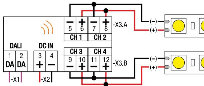
Abb. 7 - Profil: 2 CH DIM
