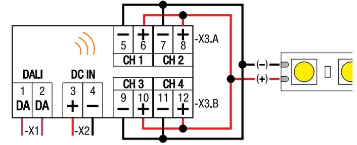
Abb. 8 - Profil: 1 CH DIM
