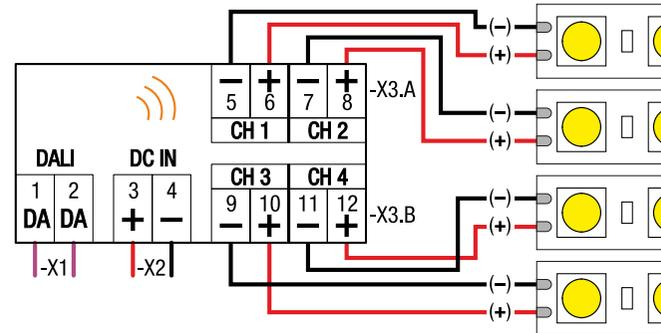
Abb. 4 - Profil: 4 CH DIM
