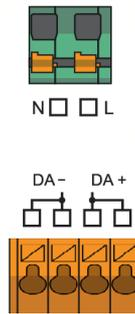
Abb.6. Anschlussbelegung DALI-2 Touchpanel PS
