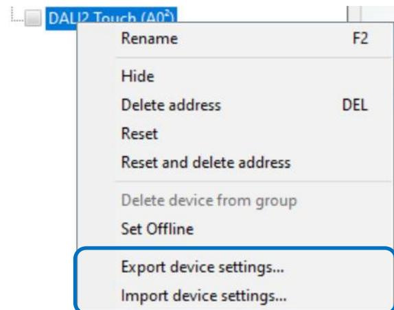
Abb.9 Gerätekonfiguration exportieren und importieren
