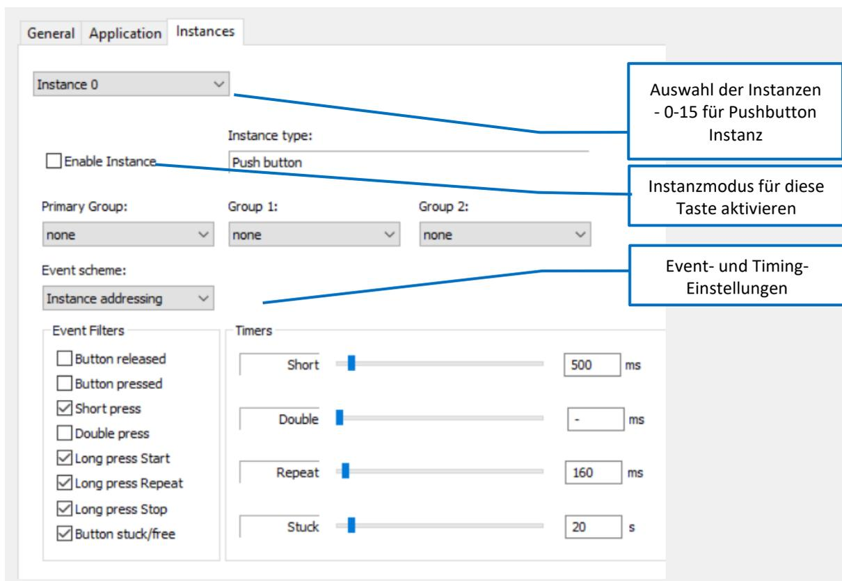
Abb.17 Instanzmodus – Pushbutton Instanzen 0-15
