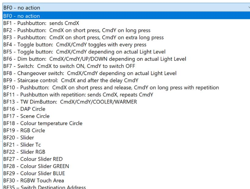
Abb.14 DALI-2 Touchpanel mögliche Button Functions
