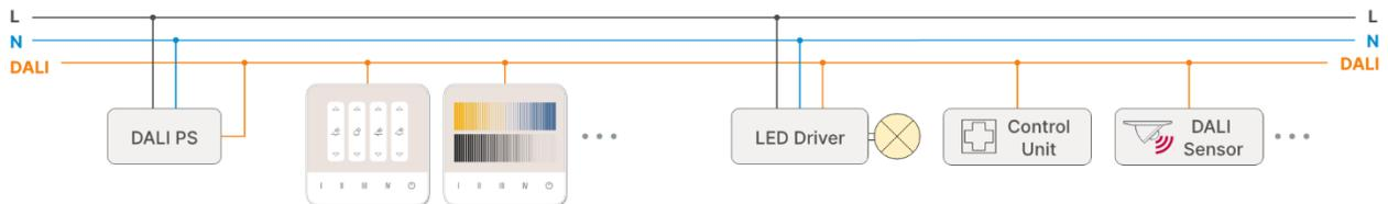
Abb.4 DALI-2 Touchpanel Typische Anwendung
