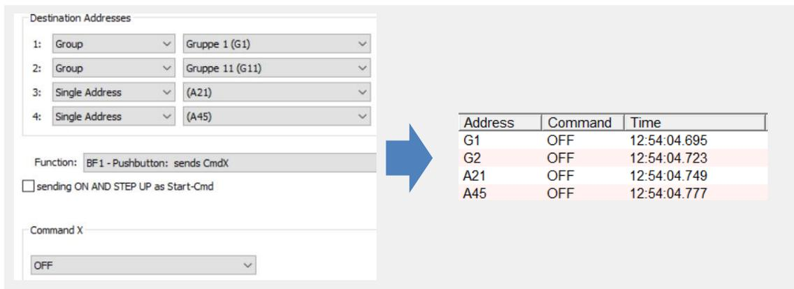
Abb.13 Beispiel sequenzielle Befehl Abarbeitung
