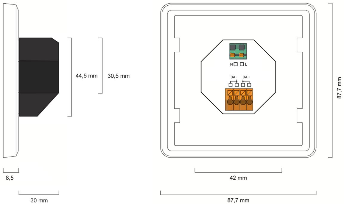
Abb.5. Abmessungen DALI-2 Touchpanel PS
