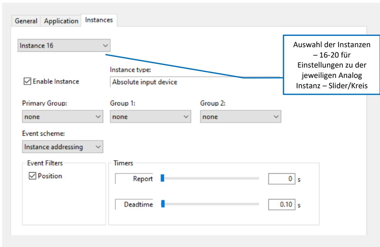
Abb.18 Instanzmodus – Analog Instanzen 16-20
