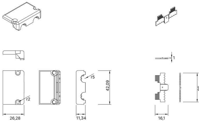
Standard Abdeckung Zugentlastung für 120x41x22mm
