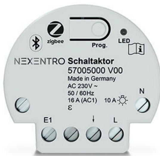
Schaltaktor mit 16A Schaltleistung zum Ansteuern von elektrischen Verbrauchern wie Leuchten, Steckdosen, Lüfter, Pumpen und vieles mehr in einem Zigbee 3.0 System. Das Modul besitzt einen Eingang zum Anschluss von Schaltern oder Tastern. Konfiguration und sofortiger Funktionstest über die Taste Prog. Die Installation erfolgt in der Gerätedose hinter dem Schalter oder Taster.
