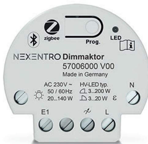
Universaldimmaktor für das Dimmen von Licht z.B. von LED-Leuchten, Hoch- und Niedervolt-Halogenlampen in einem Zigbee System. Er arbeitet nach dem Phasen- oder Phasenabschnittsprinzip und stellt dieses automatisch zur Last passend ein. Das Modul besitzt einen Eingang zum Anschluss eines Tasters. Konfiguration und sofortiger Funktionstest über die Taste Prog. Die Installation erfolgt in der Schalterdose hinter einem Taster.
