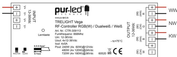
Info: Jeder Kanal kann mit bis zu 5A belastet werden, die Kanäle WW- und CW- werden jeweils gemeinsam angesteuert, die für tripleweiß werden einzeln gesteuert.
