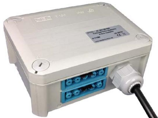
Das BL-201-09-868 EnOcean-DALI-Gateway bietet einen DALI Master sowie ein integriertes DALI Netzteil für den direkten Anschluss von bis zu 10 Slaves (I<sub>out</sub> max.= 20 mA), ohne dass ein separates DALI Netzteil erforderlich ist. Zusätzlich ist EnOcean Funk-Transceiver integriert. Diese Eigenschaften ermöglichen die einfache und problemlose Kombination aus DALI Slaves / Verbrauchern und drahtloser EnOcean Technologie. Der BL-201-09-868 wird direkt über 230 V AC Netzspannung versorgt.
