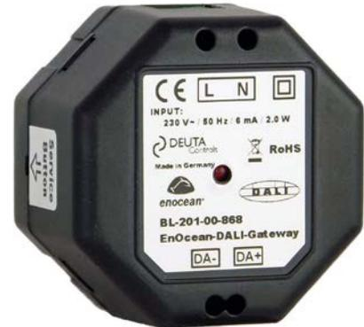
Das BL-201 EnOcean-DALI-Gateway bietet einen DALI Master sowie ein integriertes DALI Netzteil für den direkten Anschluss von bis zu 10 Slaves (I<sub>out</sub> max.= 20 mA), ohne dass ein separates DALI Netzteil erforderlich ist. Zusätzlich ist EnOcean Funk-Transceiver integriert. Diese Eigenschaften ermöglichen die einfache und problemlose Kombination aus DALI Slaves / Verbrauchern und drahtloser EnOcean Technologie. Der BL-201 wird direkt über 230 V AC Netzspannung versorgt.
