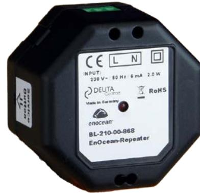
Der BL-210 EnOcean-Repeater bietet einen EnOcean Funk-Transceiver, welcher wahlweise als Level 1 oder Level 2 Repeater zur Erhöhung der Funkreichweite zwischen EnOcean Sensoren, EnOcean Aktoren und Steuerungstechnik mit EnOcean-Schnittstelle arbeitet. Das Gerät wird direkt über 230 V AC Netzspannung versorgt. Die Auswahl der Funktion erfolgt über den Servicetaster.
