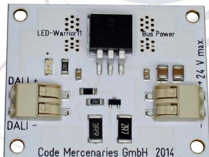
Das LED-Warrior11-MOD erzeugt die Stromversorgung für einen DALI-Bus.
