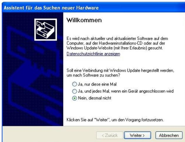
Verbinden Sie das Lichtmeter LM10L über das USB-Kabel mit dem PC. Schalten Sie das LM10L ein und aktivieren den USB-Modus (→ Fehler: Referenz nicht gefunden). Am PC erscheint das Fenster des Hardware-Assistenten. Wählen Sie bei der Frage nach einem Windows-Update: *Nein, diesmal nicht*. Klicken Sie auf *Weiter*.
